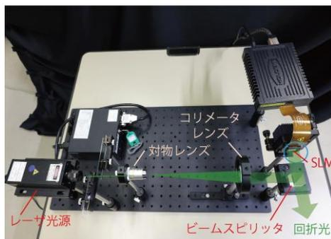
図3 4K解像度ホログラフィックプロジェクタ
